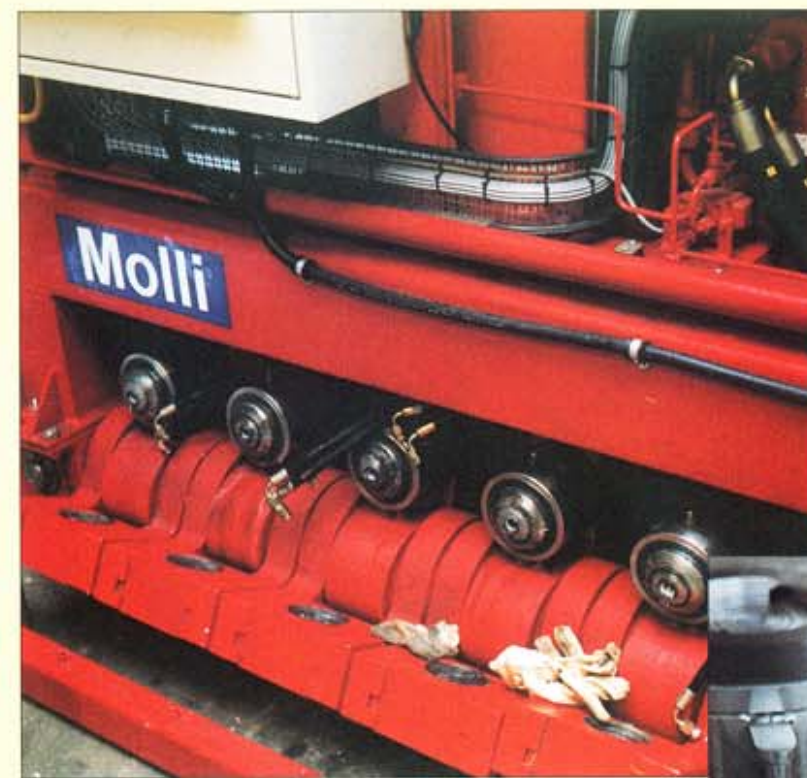
◀ Cylindrar för bromsok på hydrauliskt "lok" vid varv i Rostock.
